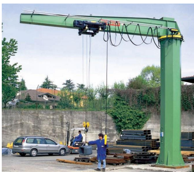
Ilustración 6. Grúa pluma fija de columna de baja capacidad. Foto extraída de catálogo. https://goo.gl/NJ2XHZ
