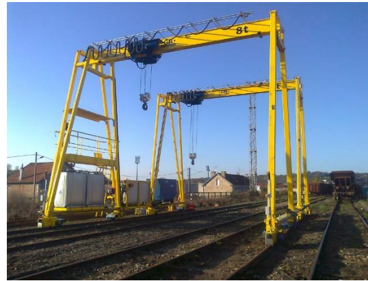
Ilustración 13. Grúa pórtico. https://goo.gl/3HbhD1
