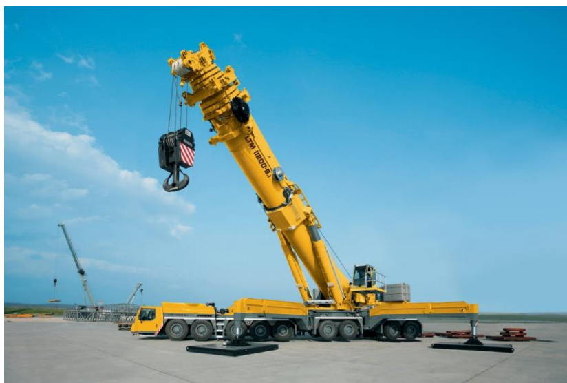
Ilustración 4. Grúa móvil de gran capacidad (1200 Tn). Foto extraída del fabricante Liebherr. https://goo.gl/62RoJM
