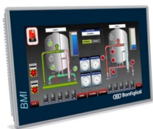
Ilustración 58. Interfaz de control BMI SC, según el fabricante Bonfiglioli.
