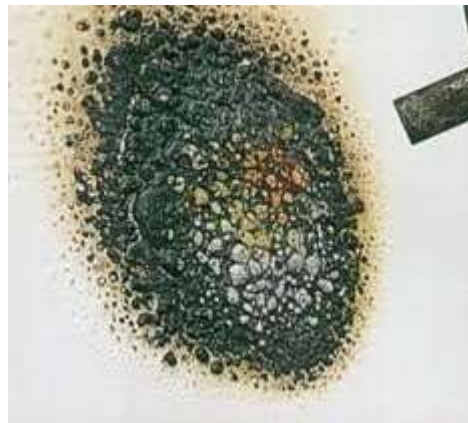
Ejemplo de protección pintura intumescente. Fuente: Foto de Pinturas Angar
