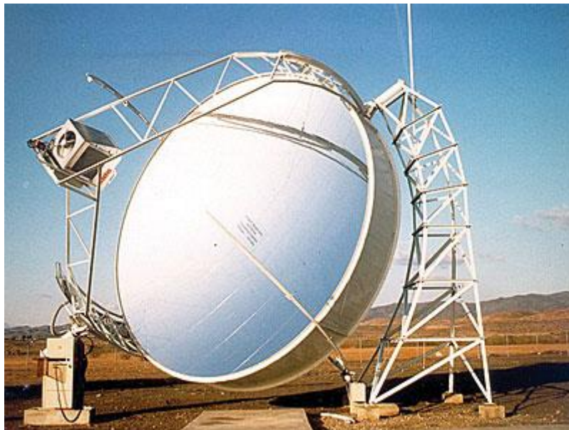
Fig. 14: Disco parabólico con motor Stirling [10]
