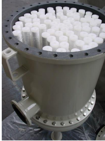
Figura 8: Interior de un tubo con filtros de cartuchos (Fuente: www.putschnerva.com )
