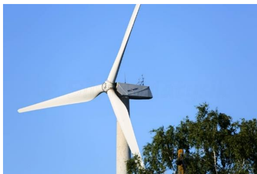
Figura 39: Aerogenerador D6 62/1250kW de DeWind (Fuente: www.en.wind-turbine-models.com )
