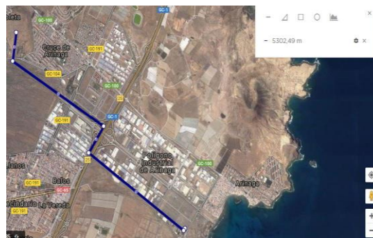
Figura 30: Longitud de la tubería de distribución desde la EDAM hasta el depósito regulador (Fuente: Goolzoom)
