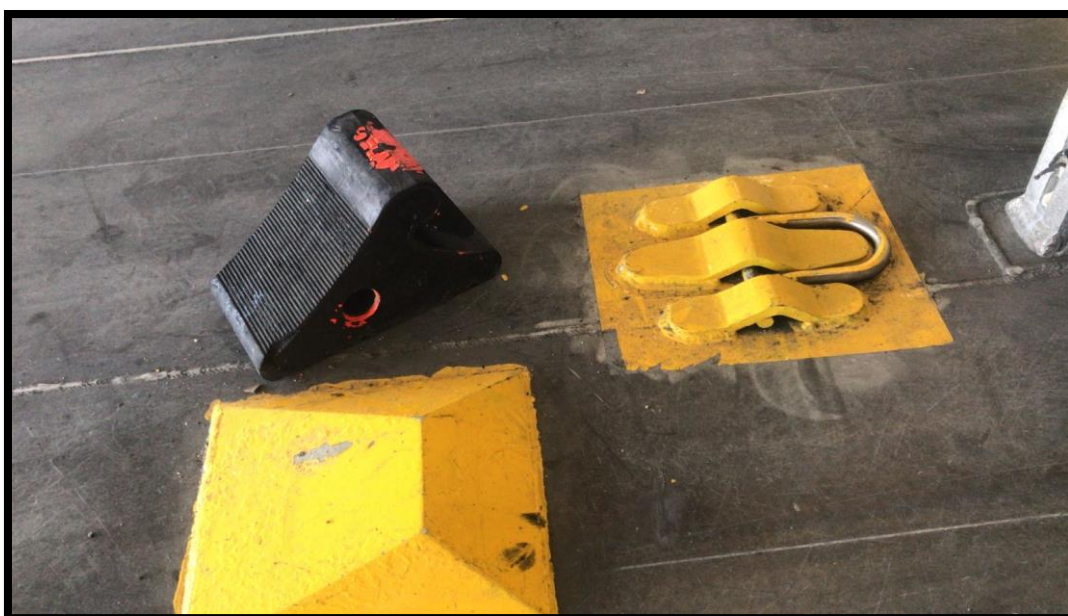
Ilustración 42. Tacos para el trincado. Fuente: Trabajo de campo.
