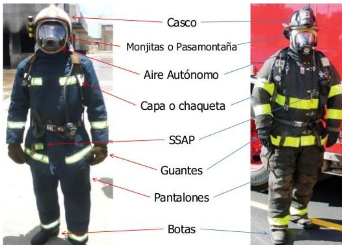
Ilustración 33. Equipo de contraincendios. Fuente: es.slideshare.net
