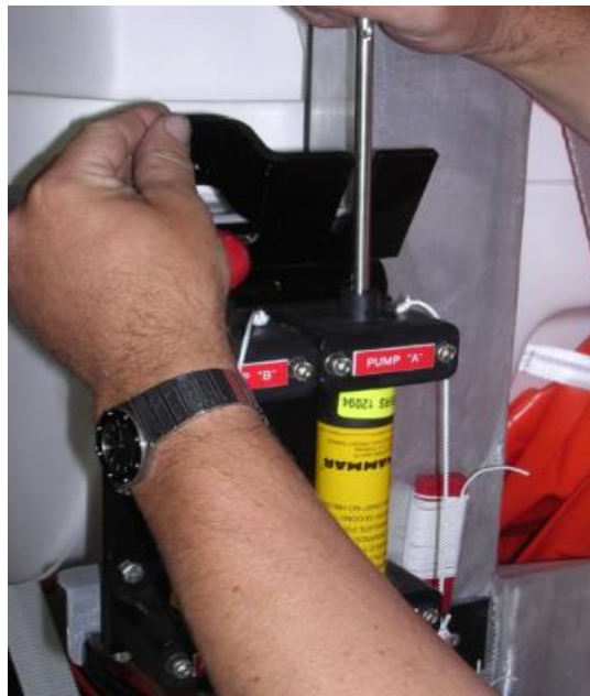
Ilustración 23. Accionamiento local del sistema MES. Fuente: LSA Formación (Fred Olsen)
