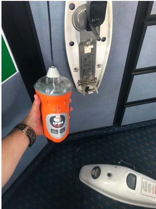
Ilustración 29. EPIRB interior. Fuente: T. de campo.
