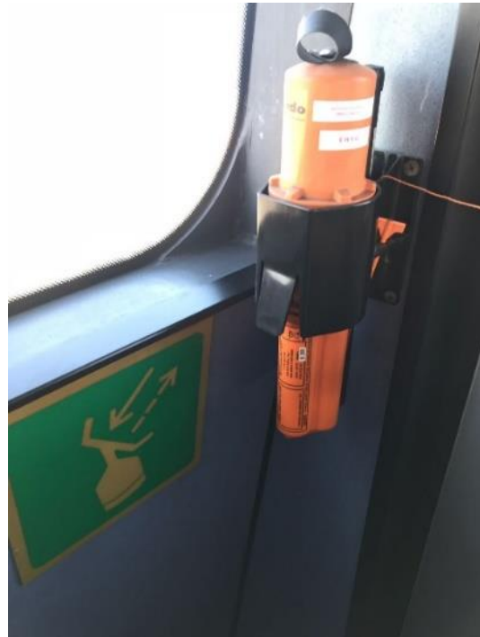
Ilustración 30. Transpondedor radar. Fuente: T. de campo.
