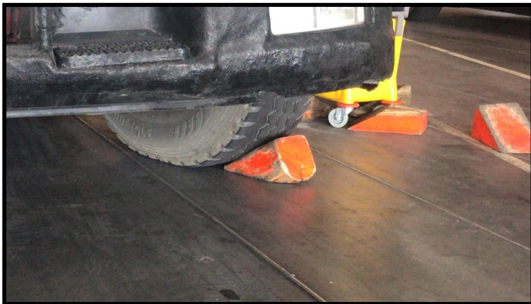
Ilustración 41. Trincado de vehículos. Fuente: Trabajo de campo.
