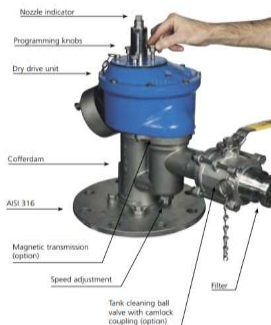
Ilustración 58. Elementos Máquina Scanjet. Fuente: Scanjet Systems
