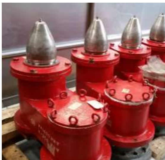
Ilustración 32. PV's semejantes a las del Tinerfe. Fuente: Niu Bros Marine Services
