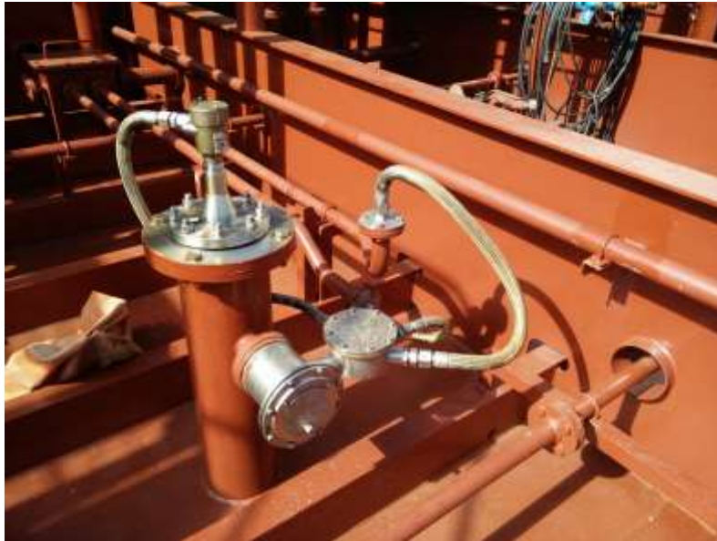
Ilustración 25. Sonda-Radar B/Q Tinerfe. Fuente: Trabajo de Campo
