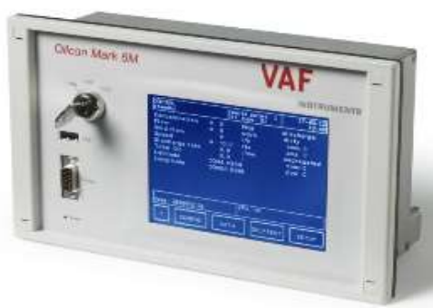
Ilustración 40. Sistema ODME semejante al del Tinerfe. Fuente: Trabajo de Campo
