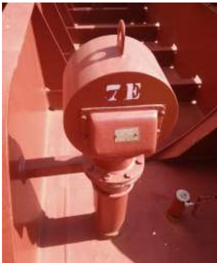
Ilustración 54. Suspiros y Plano Ventilación Tanques Lastre. Fuente: Trabajo de Campo y Manual Tinerfe
