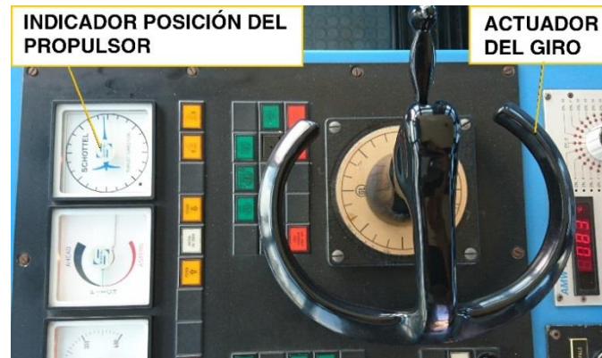
Figura 50. Controles en el puente del giro del propulsor. Fuente: Elaboración propia.
