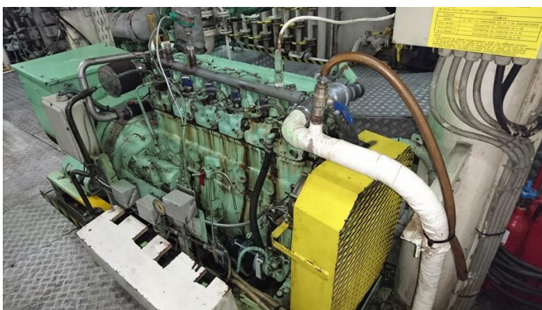
Figura 36. Motor auxiliar del buque VB-Canarias. Fuente: Trabajo de campo.
