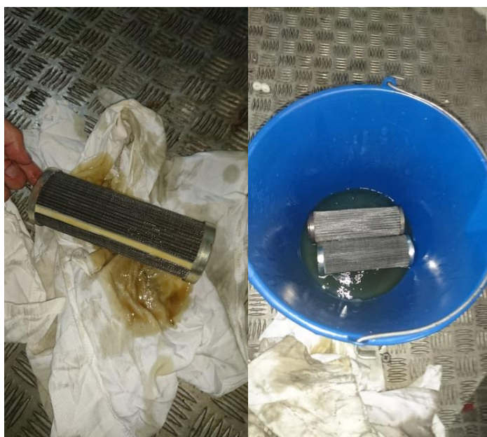
Figura 45. Proceso de limpieza de filtros de aceite pesado. Fuente: Trabajo de campo.
