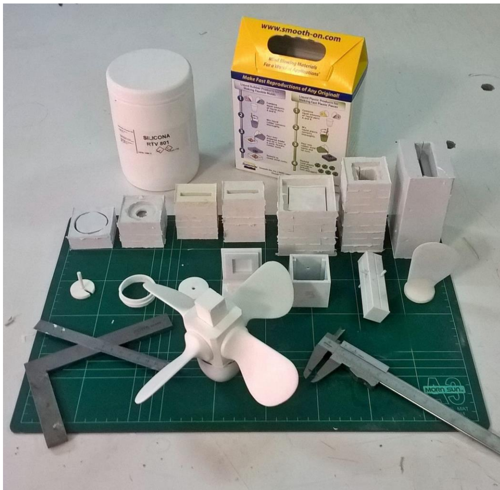
Figura 83. Moldes, piezas maestras, y modelo finalizado. Fuente: Trabajo de campo.
