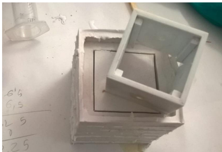
Figura 78. Extracción del modelo del molde. Fuente: Trabajo de campo.
