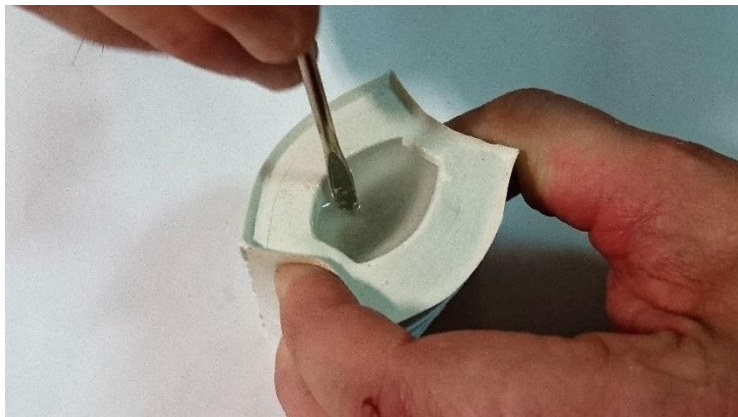
Figura 80. Eliminación de burbujas de la pieza. Fuente: Trabajo de campo.
