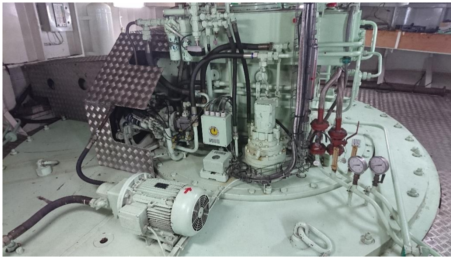
Figura 28. Propulsor modelo Schottel del buque VB-Canarias. Fuente: Trabajo de campo.
