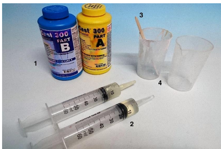
Figura 79. Elementos para la réplica de piezas. Fuente: Trabajo de campo.
