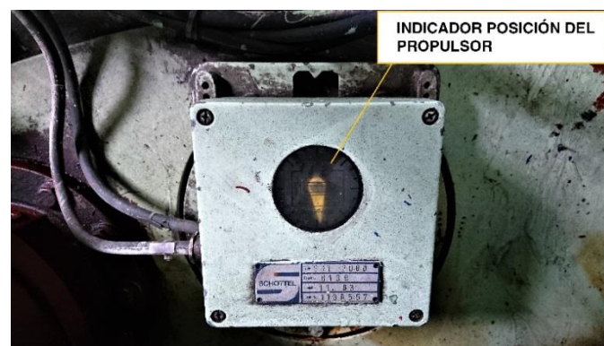
Figura 51. Indicador de la posición en la sala de máquinas. Fuente: Elaboración propia.
