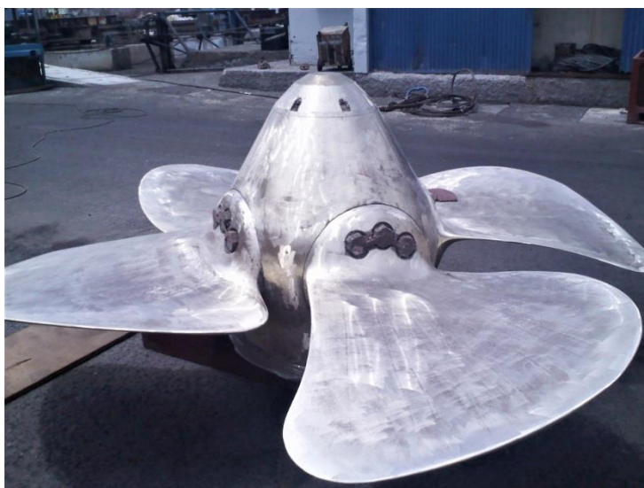
Figura 49. Hélice VB-Canarias después de pulirla. Fuente [11]
