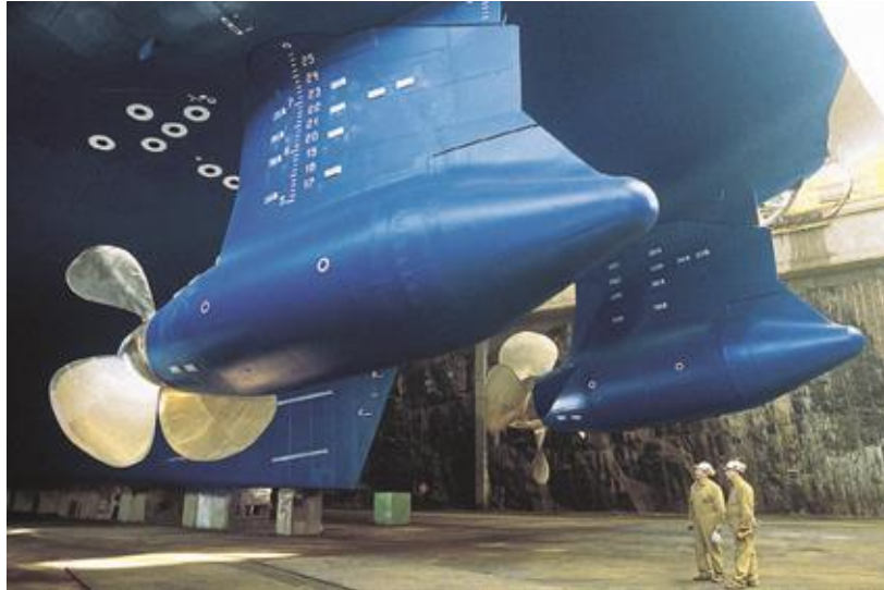
Figura 4. Propulsores azipod. Fuente: [7]
