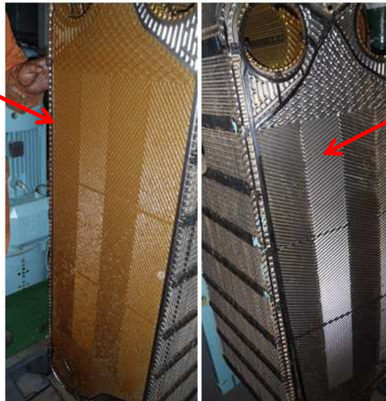
Ilustración N°30. Placas antes y después de un mantenimiento
