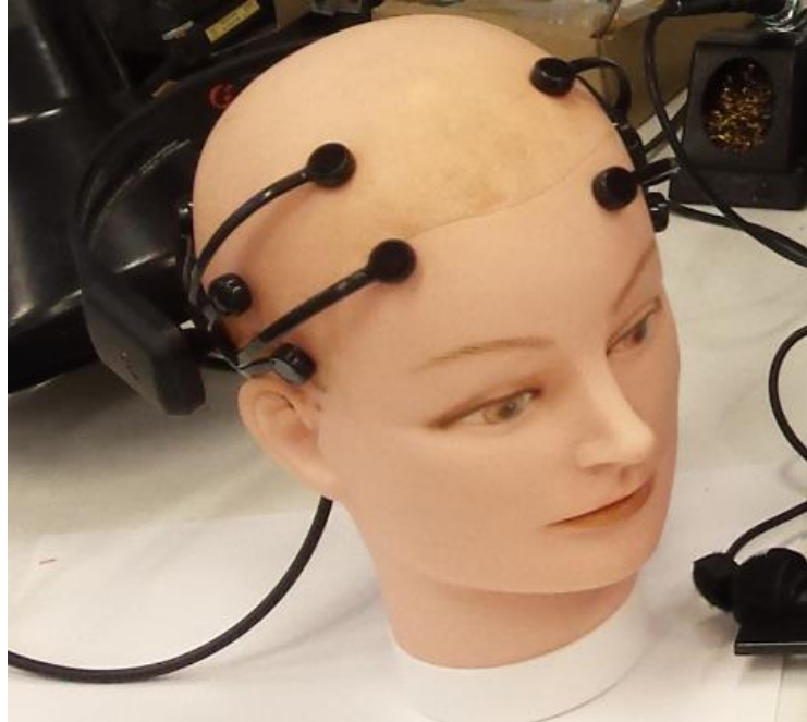
Figura 6: Soporte del dispositivo EPOC en una cabeza de maniquí.
