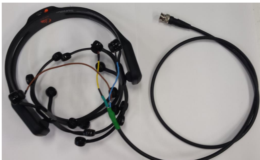
Figura 5: Dispositivo Emotiv EPOC preparado para la conexión con el calibrador
