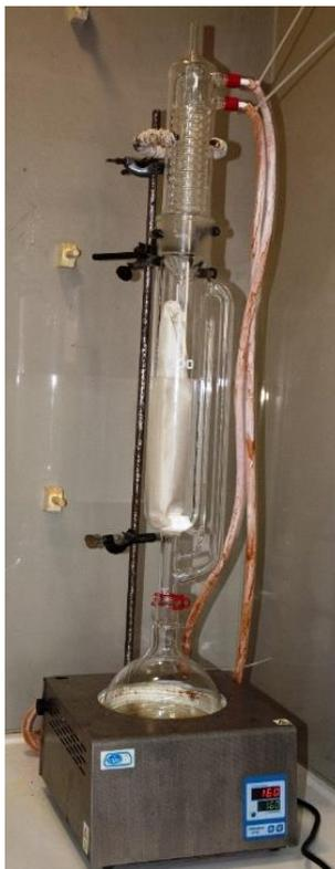
**Figura 4.4: Equipo de extracción**
