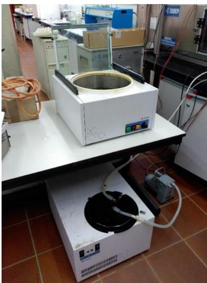
**Figura 4.7: Centrífuga-evaporadora**
