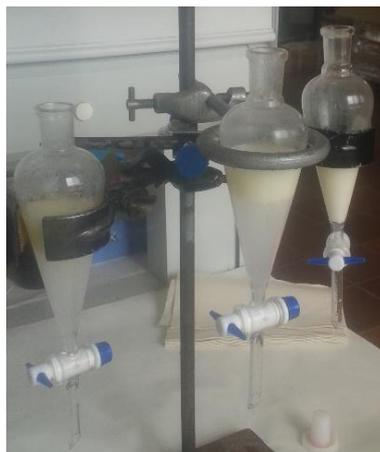
**Figura 4.8: Lavado del biodiesel**
