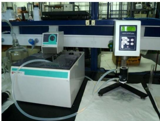
**Figura 4.11: Viscosímetro rotacional**
