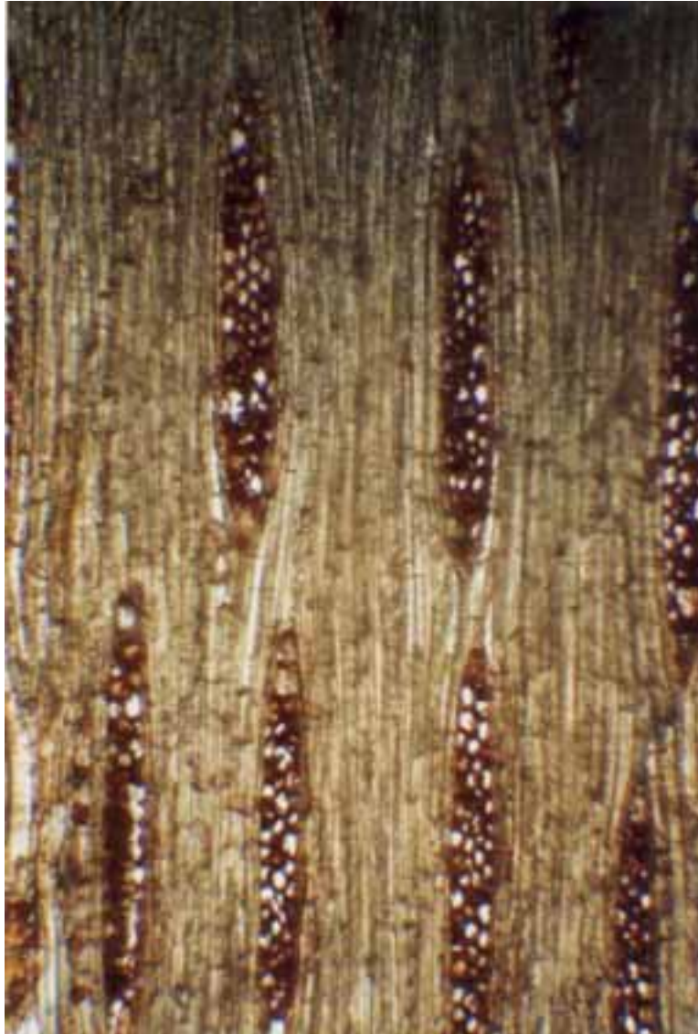
Fig. 3. 26. Radios paralelos característicos en la madera de sapelli (corte tangencial ampliación microscópica x500).
