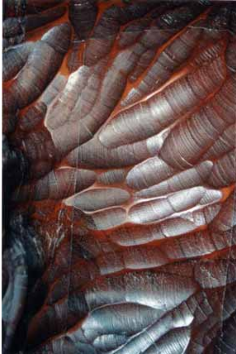
Fig. 5. 8. Madera de sapelli. Acabado realizado con goma laca sobre tapaporos nitrocelulósico.
