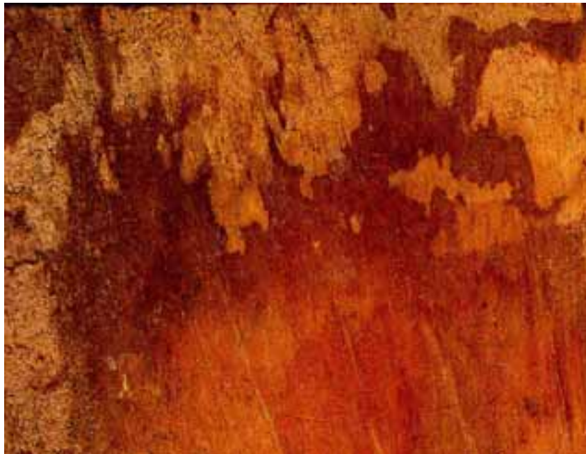
Fig. 5. 29. Ataque de pudrición blanca en una madera de cedro que ha permanecido en contacto prolongado con suelo húmedo.
