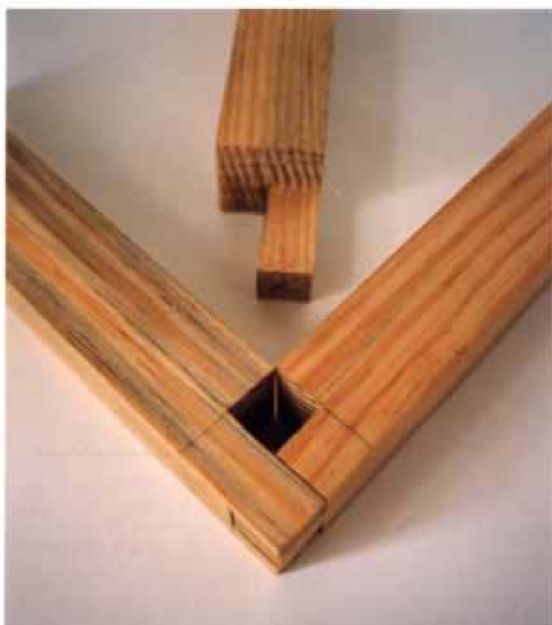
Fig. 4.61. Despiece de ensamble múltiple en esquina.
