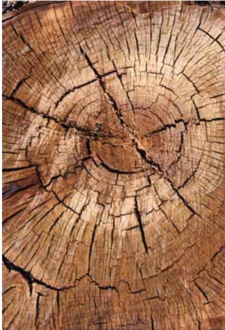
Fig. 4.7. Grietas radiales y tangenciales, producidas en un tocón ubicado a la intemperie.
