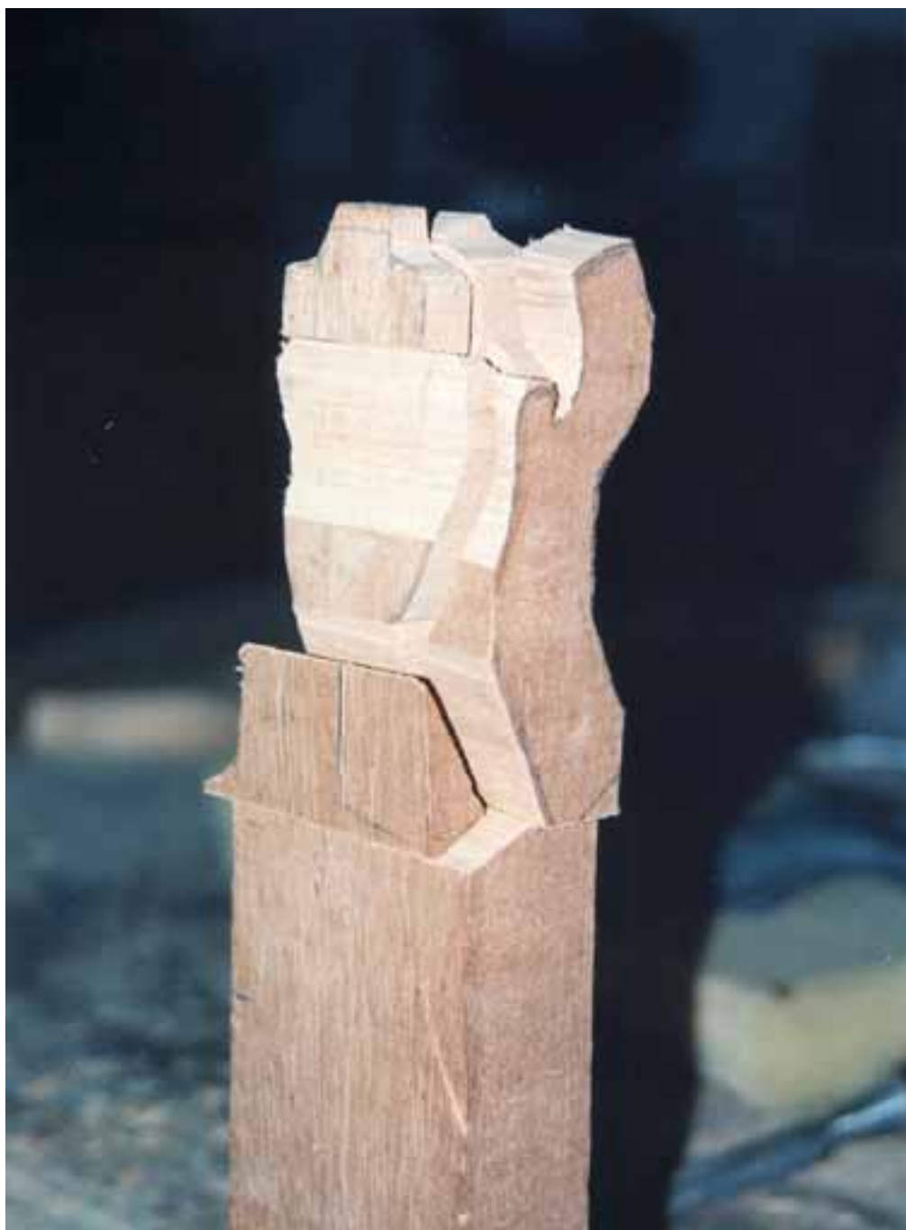
Fig. 4.10. Obtención de un volumen de pieza única, por recorte de diferentes siluetas.
