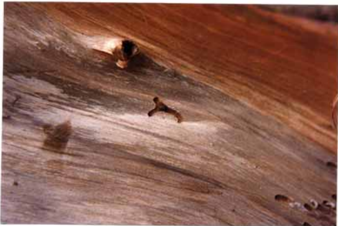
Fig. 5.22. Actuación de coleópteros sobre madera de ciprés recién cortada. En la fotografía superior se puede observar el estado larvario de los coleópteros y su deyecciones típicas.
