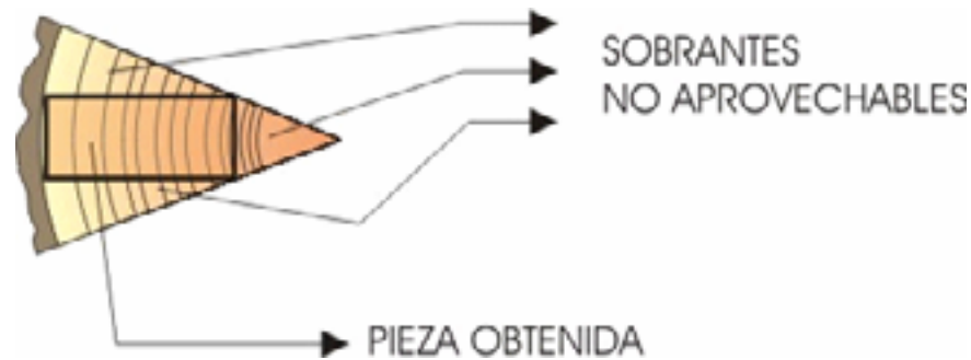
Fig. 2.6. Obtención de la sección rectangular para madera de corte radial.
