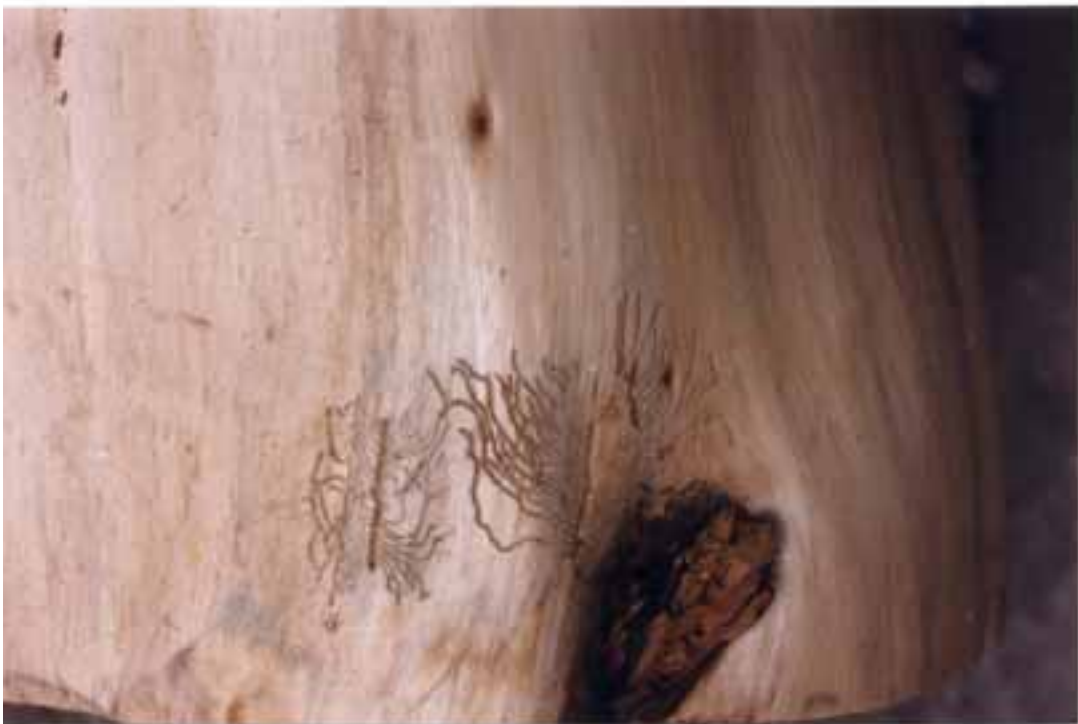
Fig. 5.23. Galerías maternas excavadas para realizar la puesta. Este tipo de ataques sólo actúa en la superficie de la madera cuando está verde, ya que este tipo de xilófagos se alimenta de los hongos producidos por la humedad (Coleópteros de la familia Scolytidae y Platypodidae, Cf. BENITO, p. 60.
