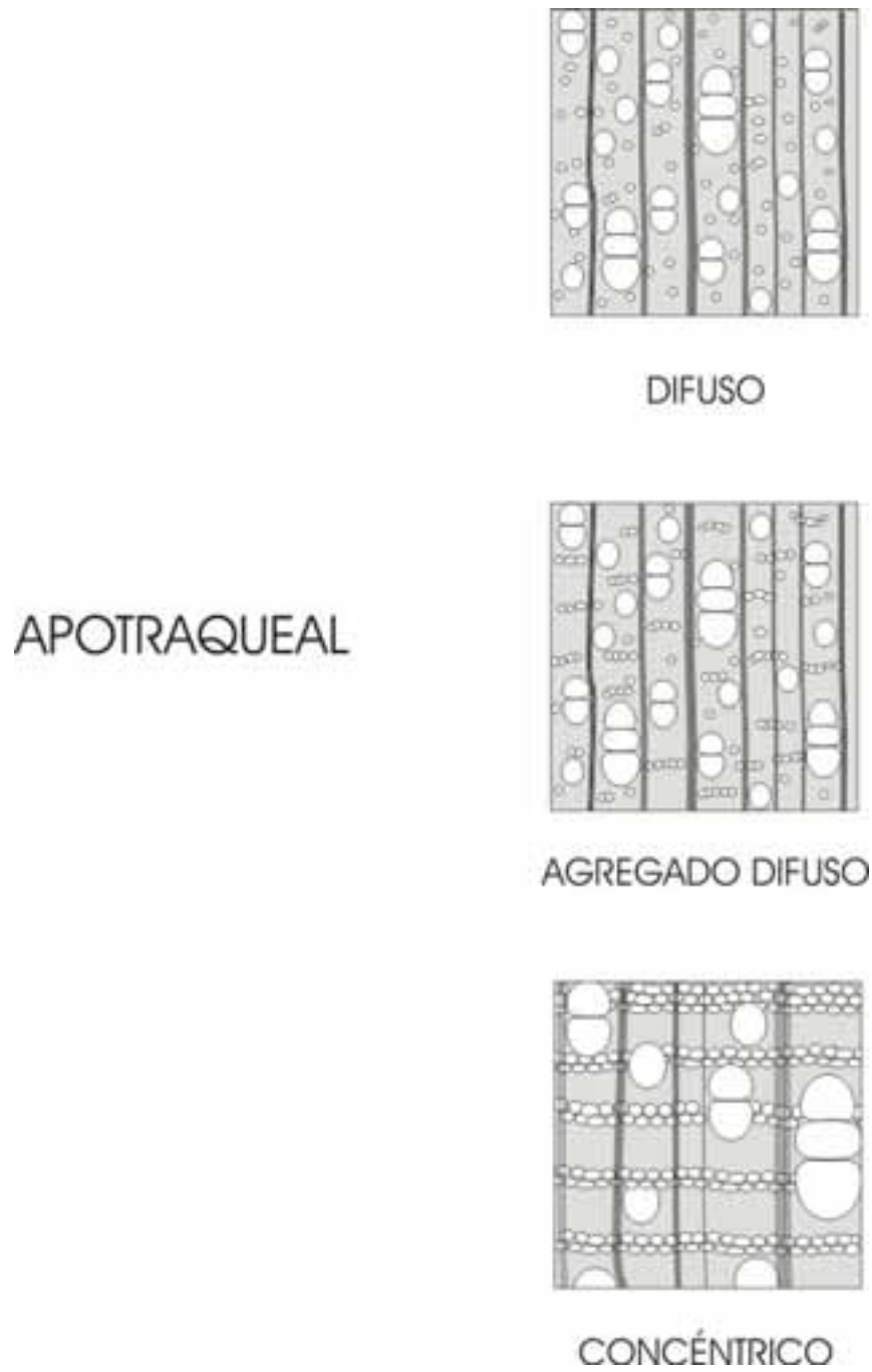
Fig. 3.20. Parénquima no ligado al tejido vascular. Sección transversal.
