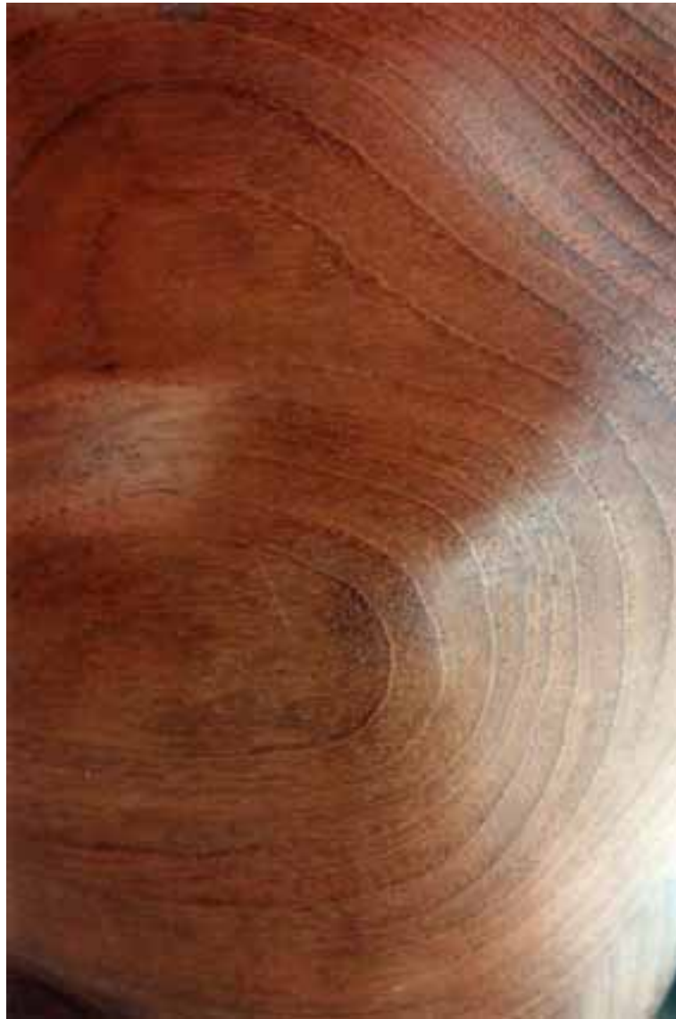
Fig. 5. 9. Madera de cedro. Acabado natural encerado. Coloración previa realizada con dicromato potásico.
