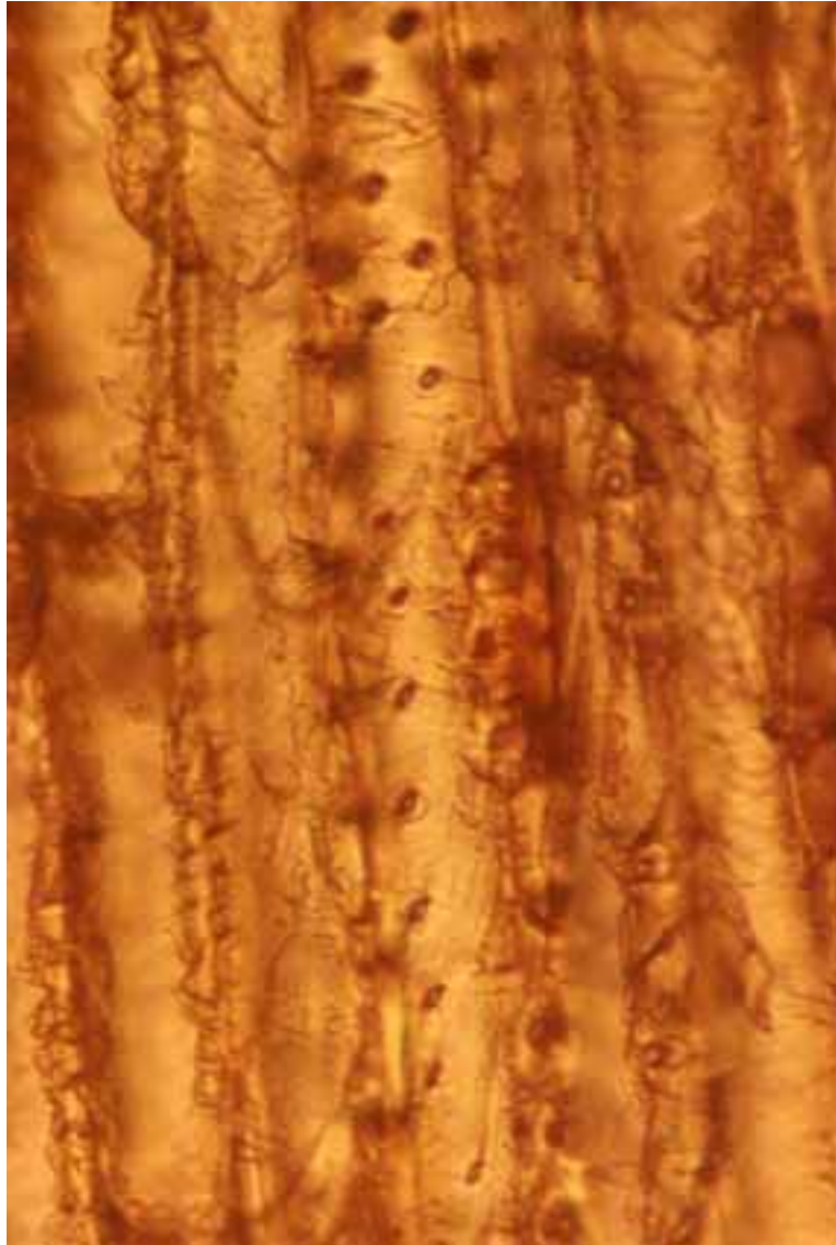
Fig. 3. 16. Fibro-traqueida con pequeñas punteaduras (ampliación x500, Juníperos cedrus ).
