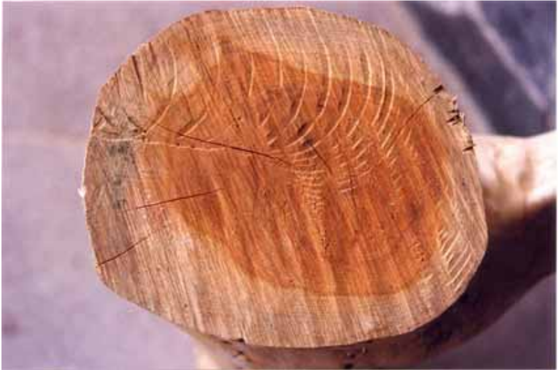
Fig. 1.4. Duramen y albura, sección transversal en la madera de Ciprés.
