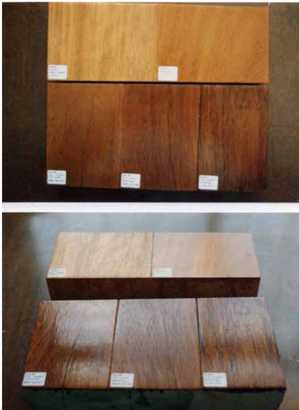
Fig. 5. 6. Madera de morera tratada con laca satinada y goma laca (foto superior), y con laca brillante, satinada y goma laca (foto inferior). Los acabados muy brillantes impiden ver con claridad el grano y demás características texturales de la madera. Obsérvese las huellas de la pincelada en la muestra inferior izquierda, que en la inferior central han desaparecido con el repasado a muñeca. Obsérvese también en la 1ª fotografía la diferencia de color entre las dos primeras muestras ocasionada por el matiz naranja que imprime la goma laca.
