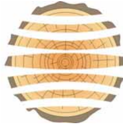
Fig. 2.12. Movimientos producidos en el aserrado paralelo. Forma aguda: pieza central.
