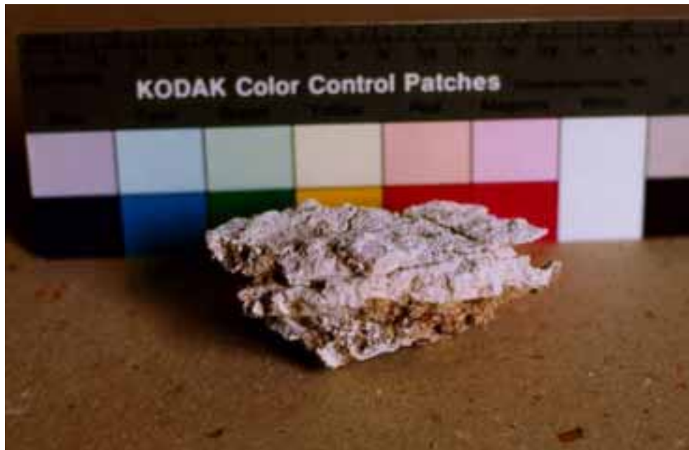
fig.V.12 CALICHES DE PROCEDENCIA CERCANA A LOS MORROS DE AVILA (AGÜMES) Muestra donde se aprecia la estructura de capas encostradas de un caliche.
