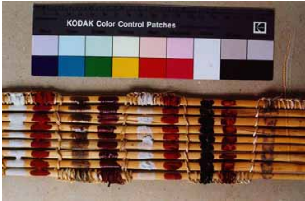
fig. II10 PRUEBAS DE APLICACIÓN SOBRE UN SOPORTE DE ORIGEN VEGETAL (juncos) CON DIVERSOS AGLUINANTES De izquierda a derecha: tina blanca y agua con gelatina de pescado, con miel de pan de azúcar, con orín y con grasa animal; en ésta última se ha añadido una aplicación de negro procedente de carbón vegetal.
