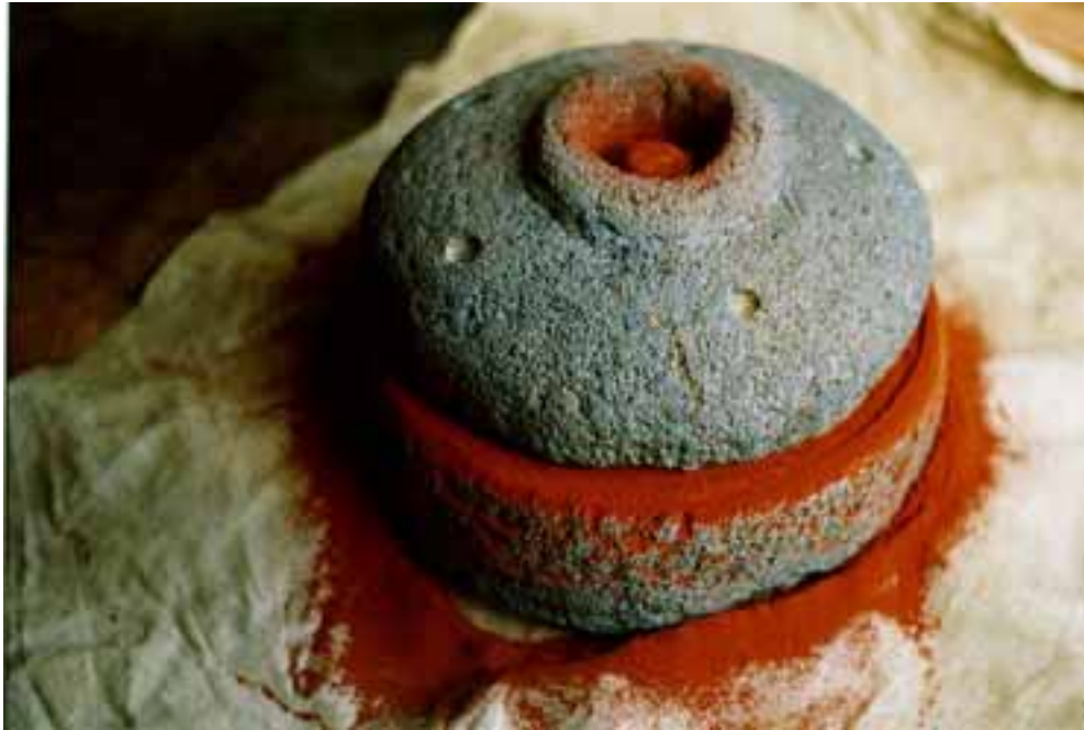
fig. V.13 PROCESO DEMOLDO DE LOS PIGMENTOS Proceso de molido de los pigmentos con un molino de piedra reproducción de un modo aborígen. Los fragmentos de tierra se introducen por la boca superior y se gira esta misma piedra con las manos o por medio de un palo.
