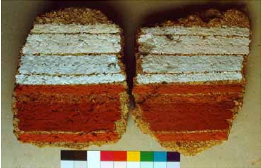
fig.V.17 PIACAS 2 y 3 Comparación de las dos placas a la exposición en el exterior de la placa 3 durante 18 meses (en la imagen la placa 3 corresponde a la situada en la derecha).
