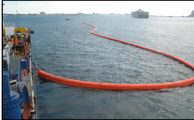
Ilustración 35: Barrera de Flotador sólido. (FUENTE: http://www.ecoestrecho.com/actualidad/reportajes/un-petrolero-contra-la-contaminacion )
