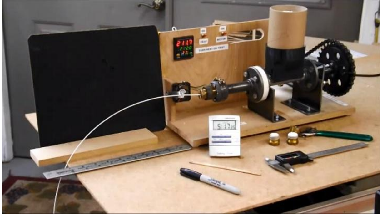
Figura 1.3.11: Muestra de la fabricación de filamento para impresión 3D a partir de máquina extrusora. [64]
