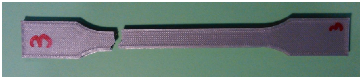
Figura 4.2.1.3.: Probeta PLA comercial tras el ensayo de tracción.
