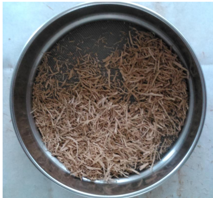
Figura 3.5.3.: Fibras de platanera en proceso de tamización para alcanzar dimensiones de 1 mm.
