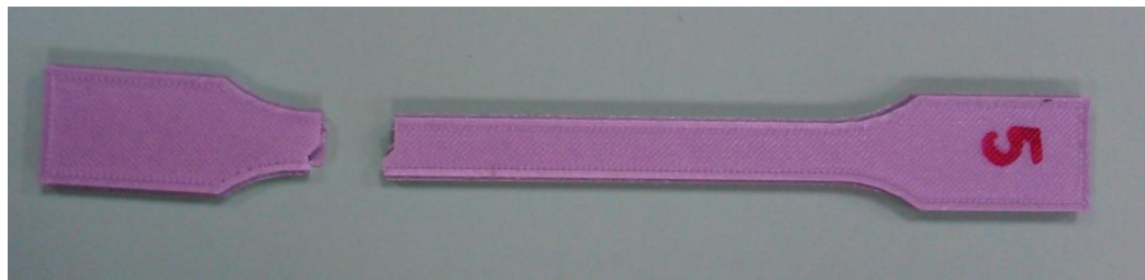
Figura 4.2.1.5.: Probeta PLA comercial tras el ensayo de tracción.
