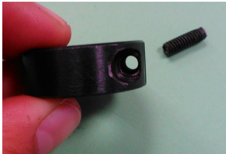
Figura 7.4.12.: Muecas realizadas en la superficie de asiento del tornillo.
