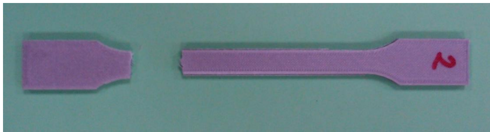
Figura 4.2.1.2.: Probeta PLA comercial tras el ensayo de tracción.
