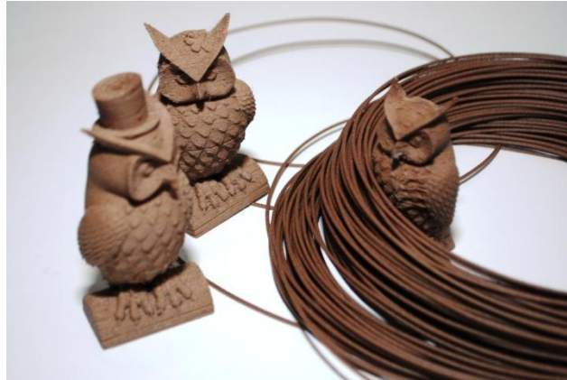
Figura 1.3.8.: Ejemplo de piezas impresas con filamento Laywood. [63]
