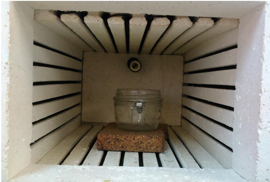
Figura 7.2.2.: Interior de la mufla con la boquilla dispuesta para el precipitado de PLA.
