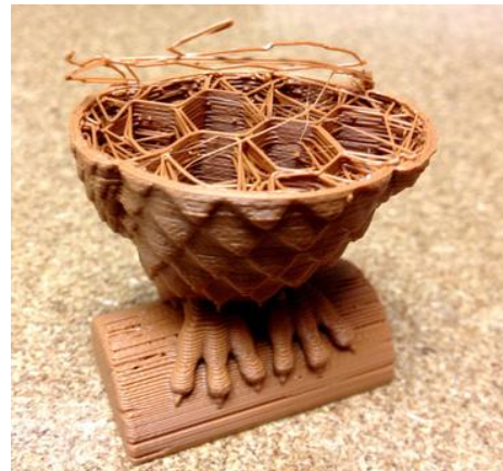
Figura 3.2.1.: Ejemplos de fallo durante la impresión 3D. [31]
