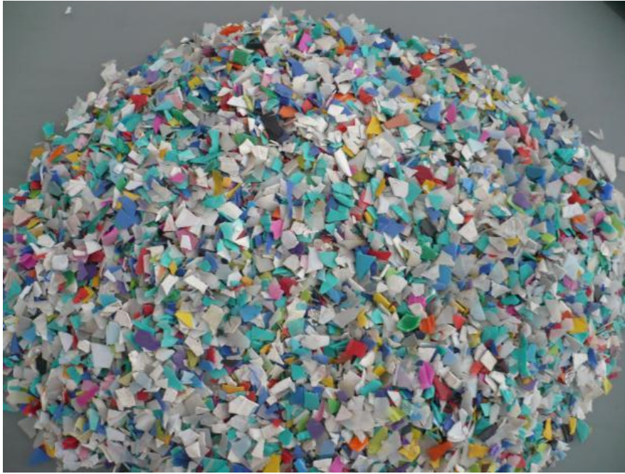
Figura 1.2.1.: Pellets de PET tras proceso de trituración. [69]
