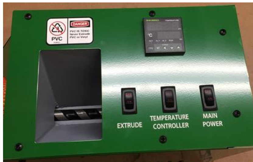
Figura 3.1.4.: Vista del control manual de la extrusora.
