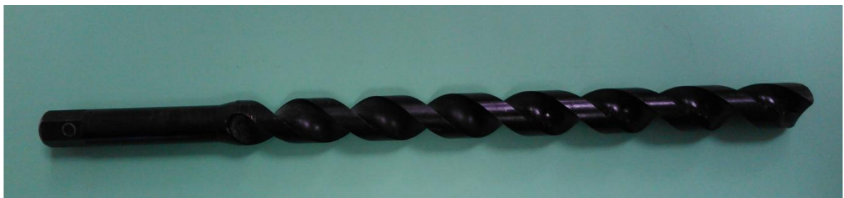
Figura 7.4.13.: Detalle de tornillo sin fin limpio tras el proceso de desmontaje y limpieza.
