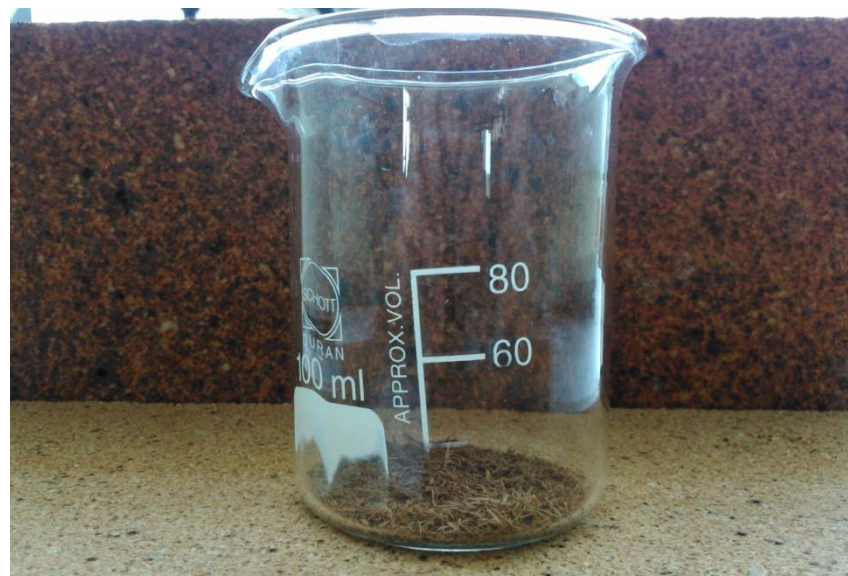
Figura 3.5.5.: Muestra de la fibra de platanera después del proceso térmico.
