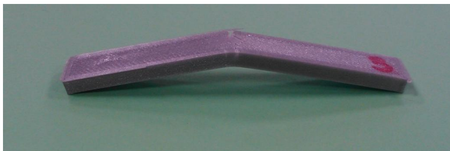
Figura 4.1.3.3.: Probeta PLA comercial tras el ensayo de flexión.
