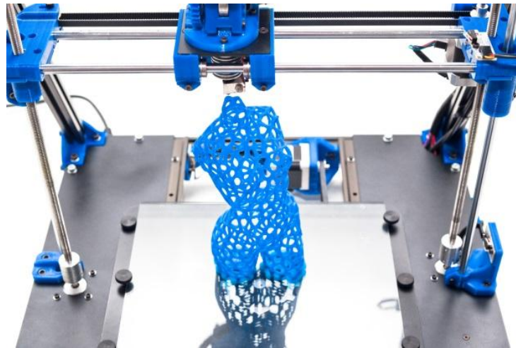
Figura 2.2.1.: Ejemplo de impresión con PLA. [28]
