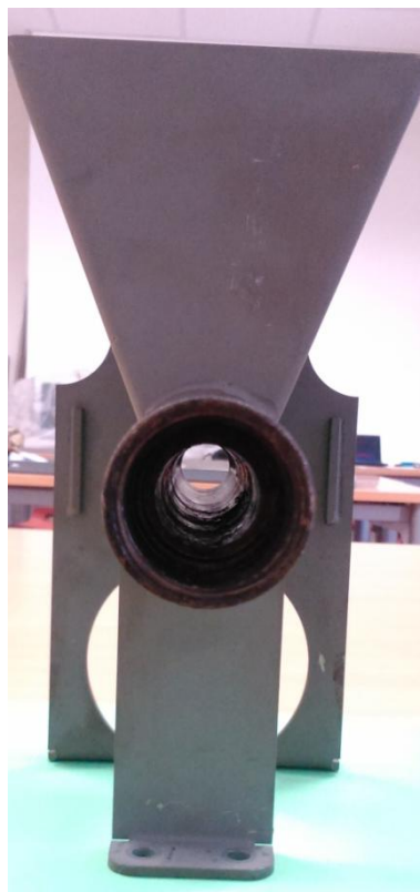
Figura 7.4.10.: Interior de la estructura que soporta el tornillo sin fin donde se aprecian pequeños restos de material adosado a las paredes.
