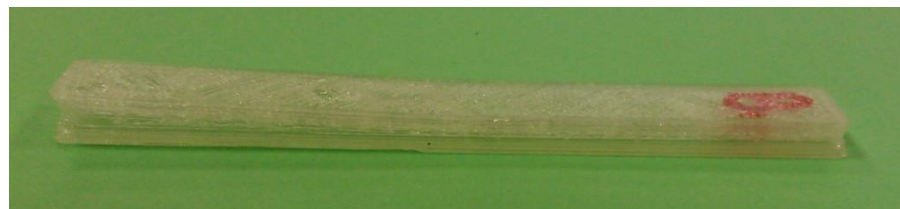
Figura 4.1.2.3.: Separación de capa inferior de la probeta de PLA fabricado tras el ensayo de flexión.
