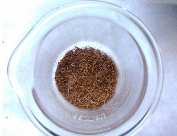
Figura 3.5.6.: Muestra de la fibra de platanera después del proceso térmico.
