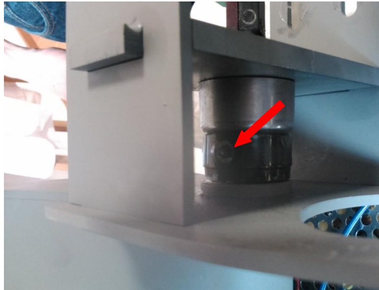
Figura 7.4.8.: Prisionero del tornillo sin fin de difícil acceso para su desunión.
