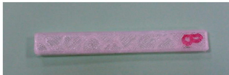
Figura 4.1.2.2.: Probeta PLA fabricado tras el ensayo de flexión.
