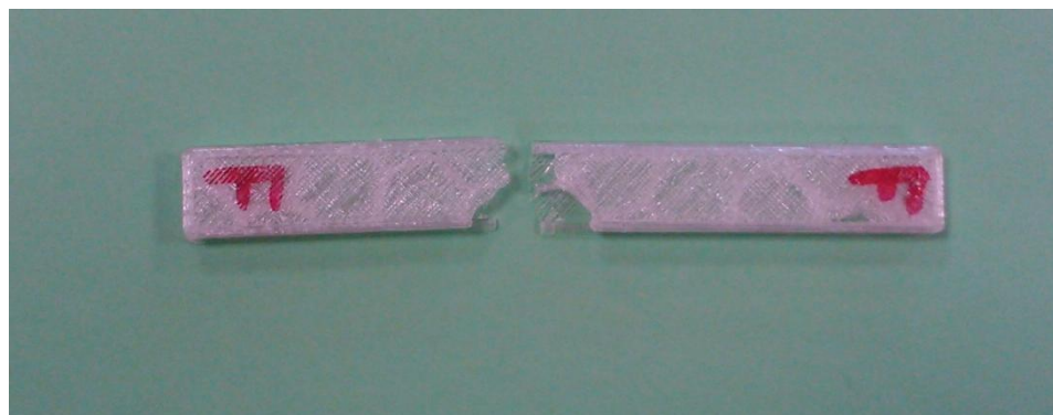
Figura 4.1.2.7.: Probeta PLA fabricado tras el ensayo de flexión.
