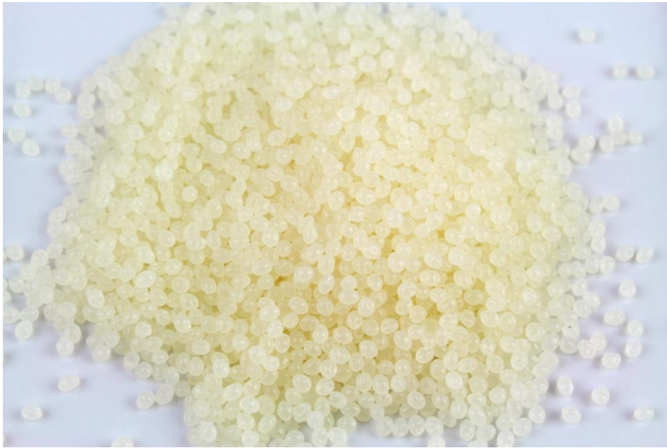
Figura 3.2.1.: Pellets de PLA empleados en al extrusión.
