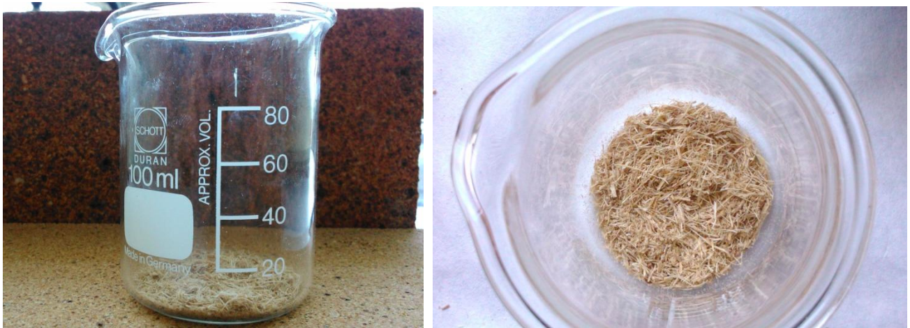
Figura 3.5.4.: Aspecto de la muestra de fibra de platanera antes del proceso térmico en mufla.
