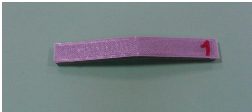
Figura 4.1.3.1.: Probeta PLA comercial tras el ensayo de flexión.
