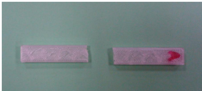
Figura 4.1.2.1.: Probetas de PLA fabricado tras el ensayo de flexión.
