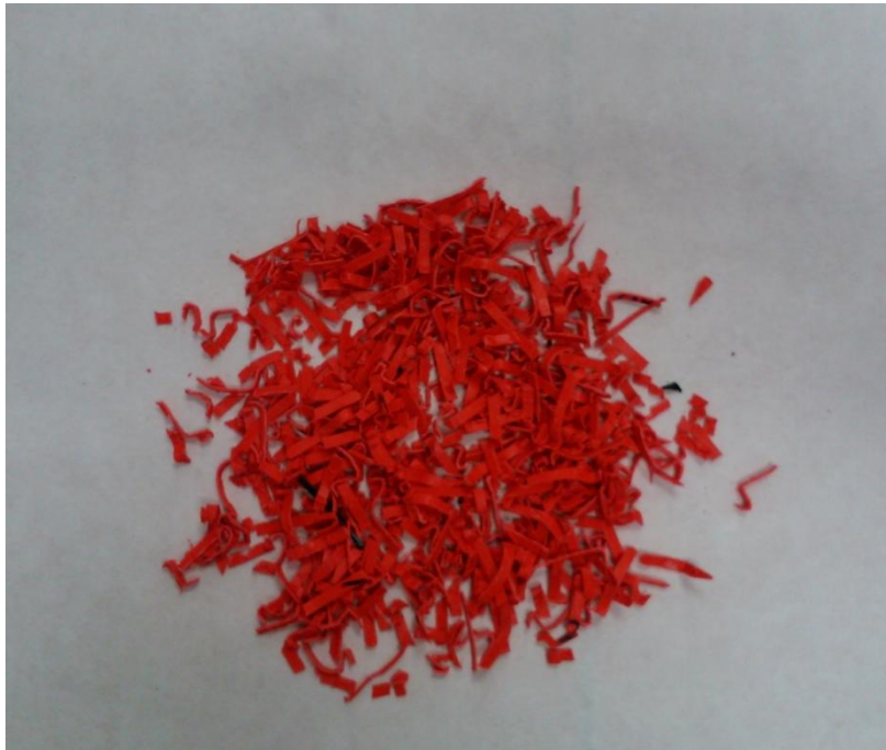
Figura 3.4.2.: PLA reciclado tras el paso de las piezas por la trituradora.
