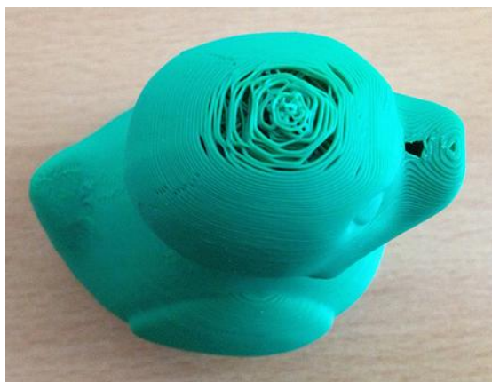
Figura 3.2.1.: Ejemplos de fallo durante la impresión 3D. [31]
