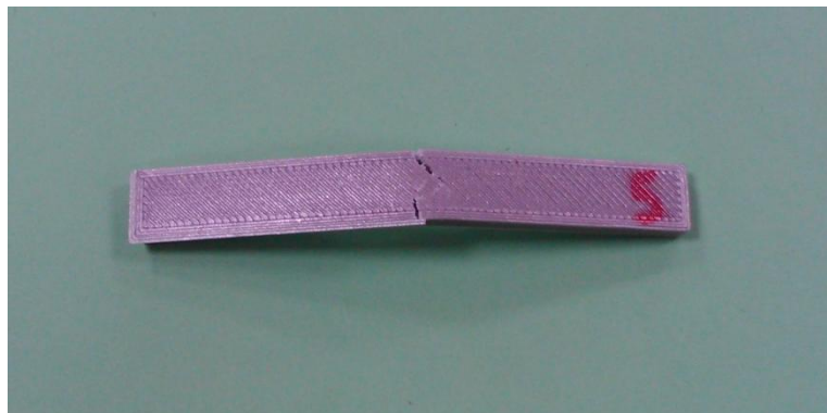
Figura 4.1.3.5.: Probeta PLA comercial tras el ensayo de flexión.
