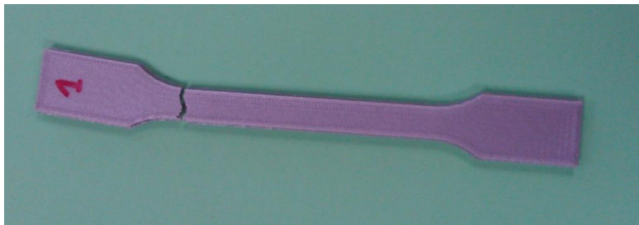
Figura 4.2.1.1.: Probeta PLA comercial tras el ensayo de tracción.
