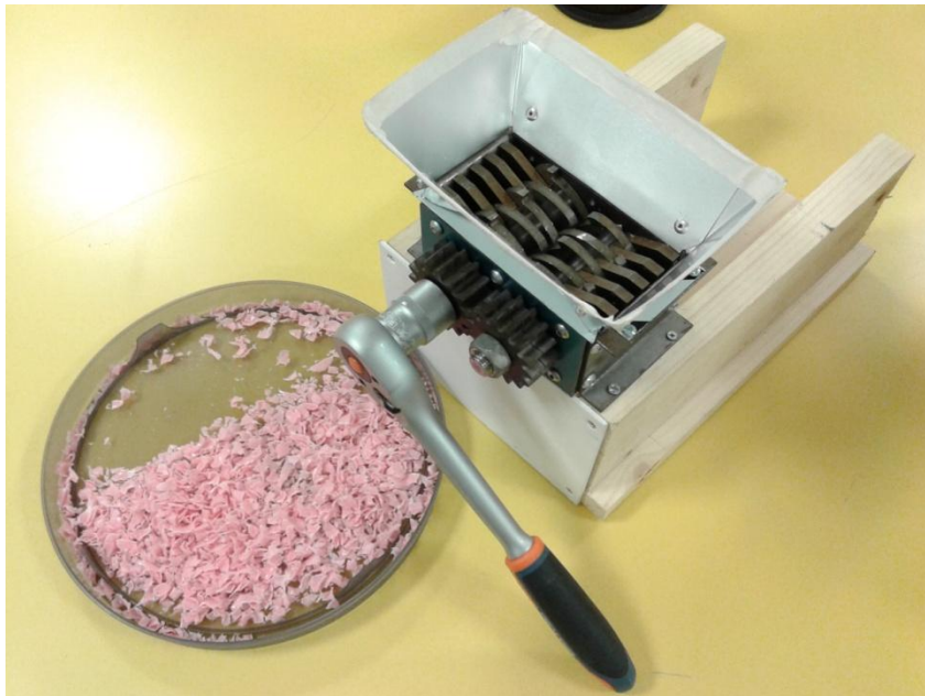
Figura 7: Pellets obtenidos a partir de la trituración de piezas de plástico. [58]
