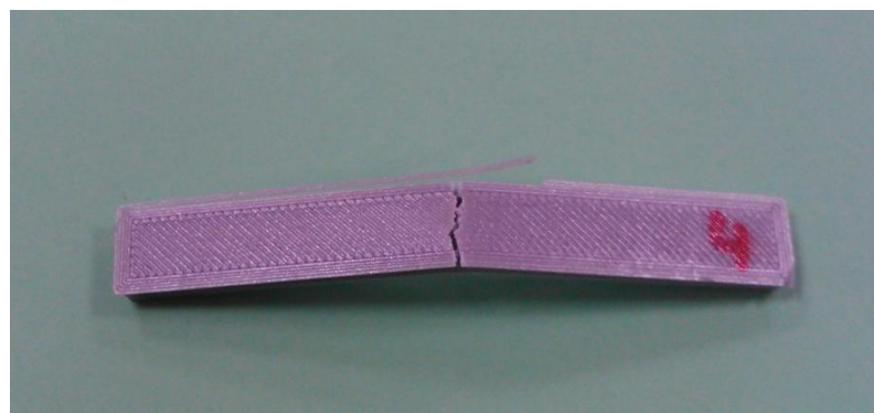
Figura 4.1.3.4.: Probeta PLA comercial tras el ensayo de flexión.
