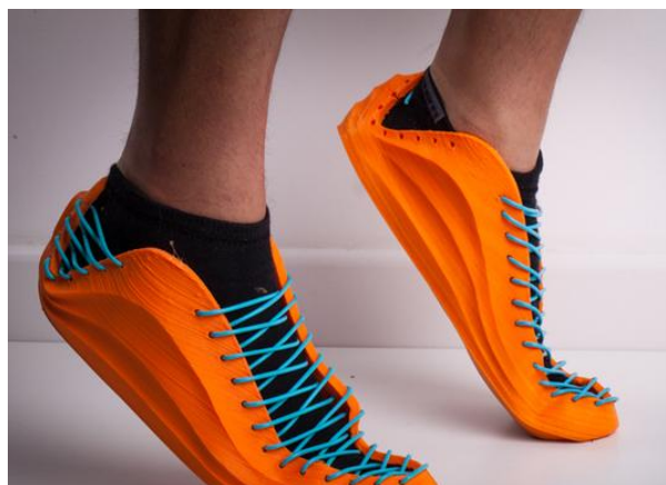
Figura 1.3.9.: Zapatillas de impresión 3D a partir de Filaflex. [23]
