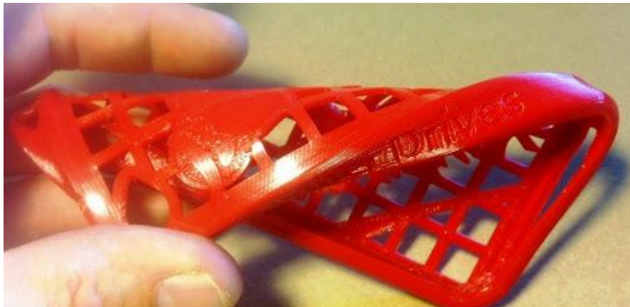
Figura 1.3.10.: Muestra de la flexibilidad del Ninjaflex.[29]
