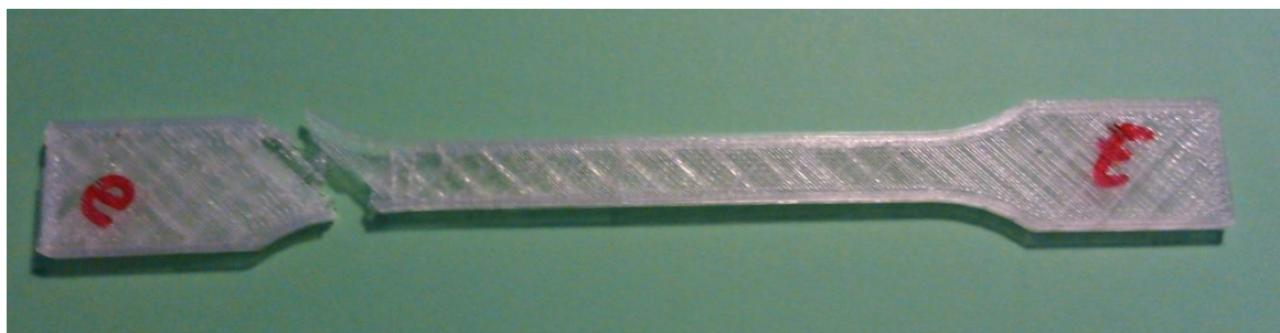
Figura 4.2.2.5.: Probeta PLA fabricado tras el ensayo de tracción.
