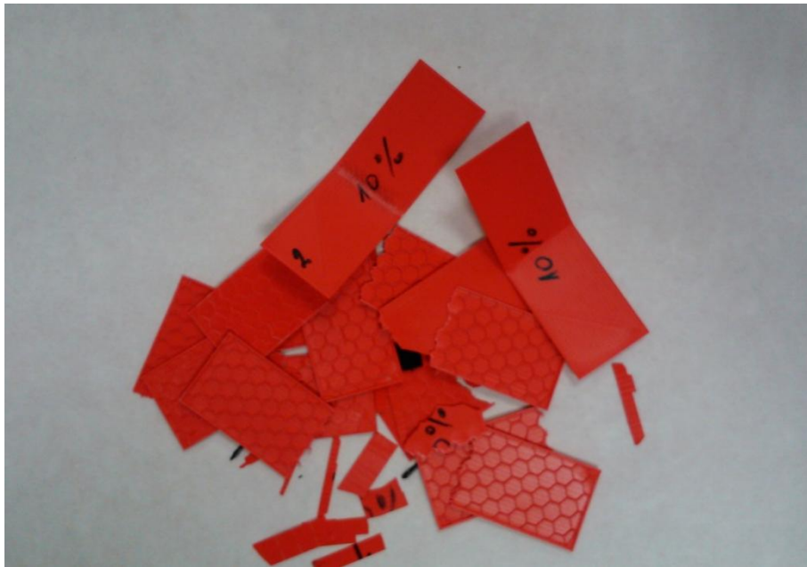
Figura 3.4.1.: Piezas de PLA impresas y ensayadas que usarán para generar carga de PLA reciclado.
