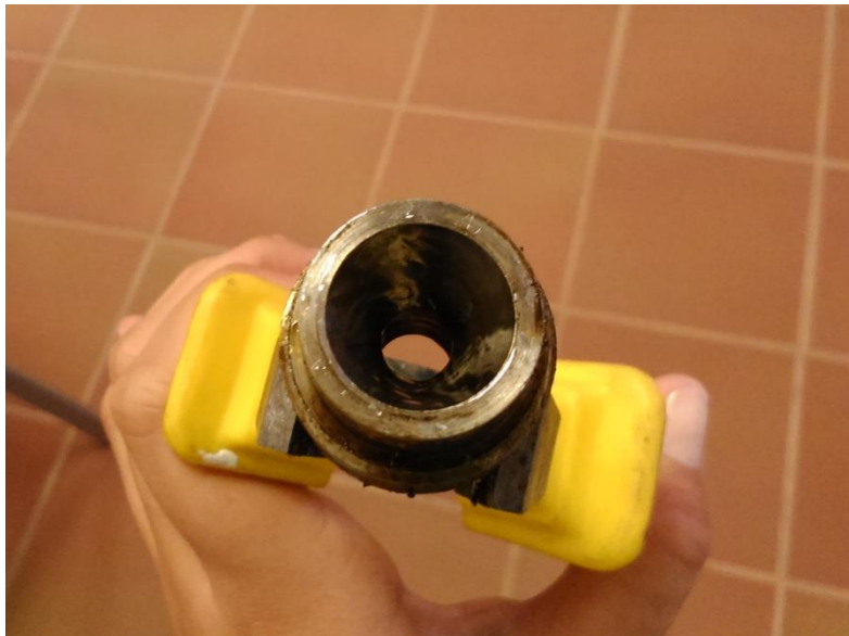
Figura 7.2.5.: Desmontaje del tornillo cónico para su limpieza.
