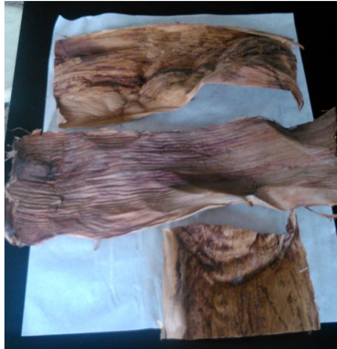
Figura 3.5.1.: Badana de platanera empleada en el procedimiento experimental.
