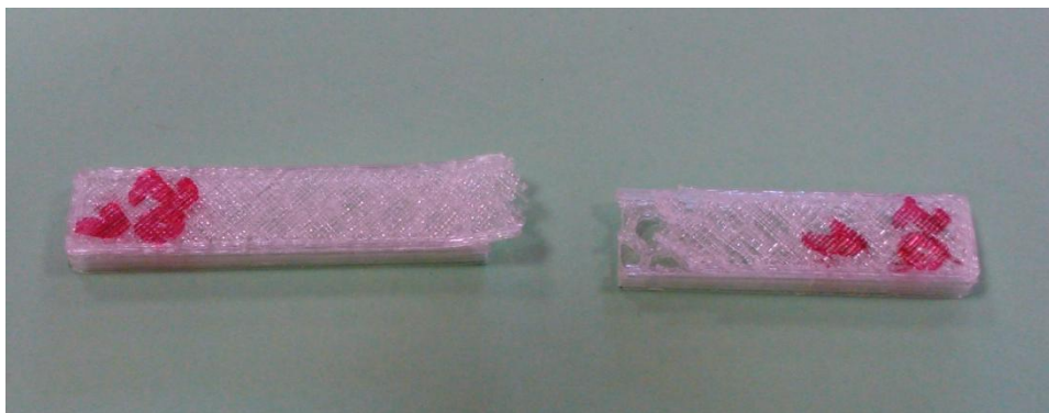
Figura 4.1.2.8.: Probeta PLA fabricado al 20% de relleno tras el ensayo de flexión.
