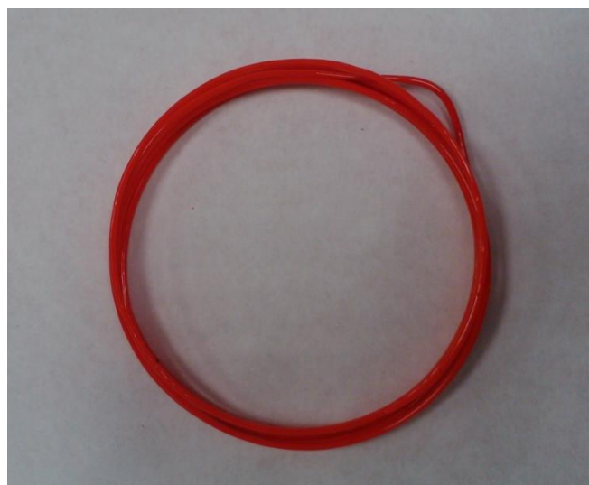
Figura 3.4.4.: Filamento de PLA + PLA reciclado que se obtiene pero que no sirve para la impresora que se dispone.
