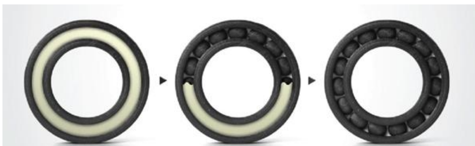
Figura 1.3.4.: Ejemplo de empleo de HIPS en impresión 3D. [29]
