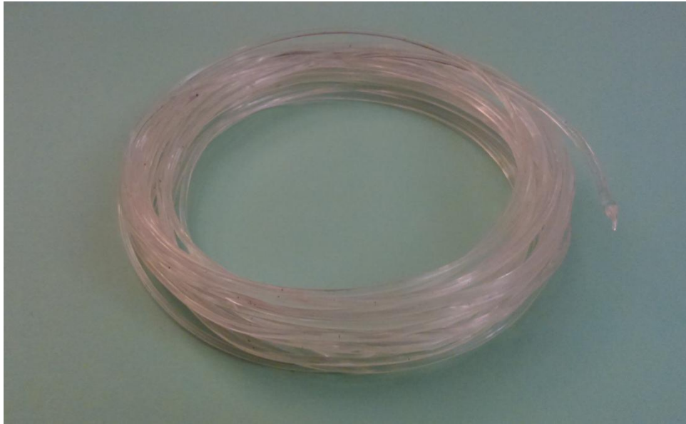
Figura 3.2.2.: Filamento de PLA obtenido con Filabot Original™.
