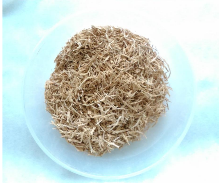
Figura 3.5.2.: Aspecto de la fibra de platanera una vez triturada.
