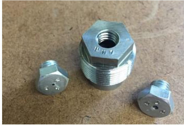
Figura 3.1.3.: Detalle de extremo de la extrusora y boquillas. [50]
