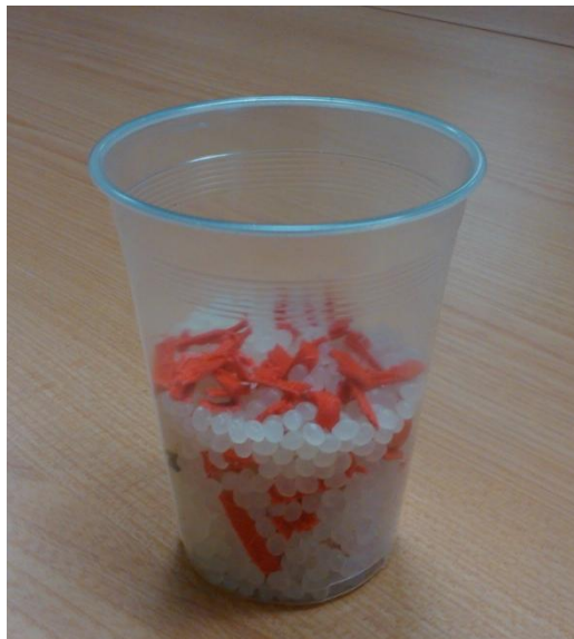
Figura 3.4.3.: Mezcla de PLA que se emplea para el proceso de extrusión.
