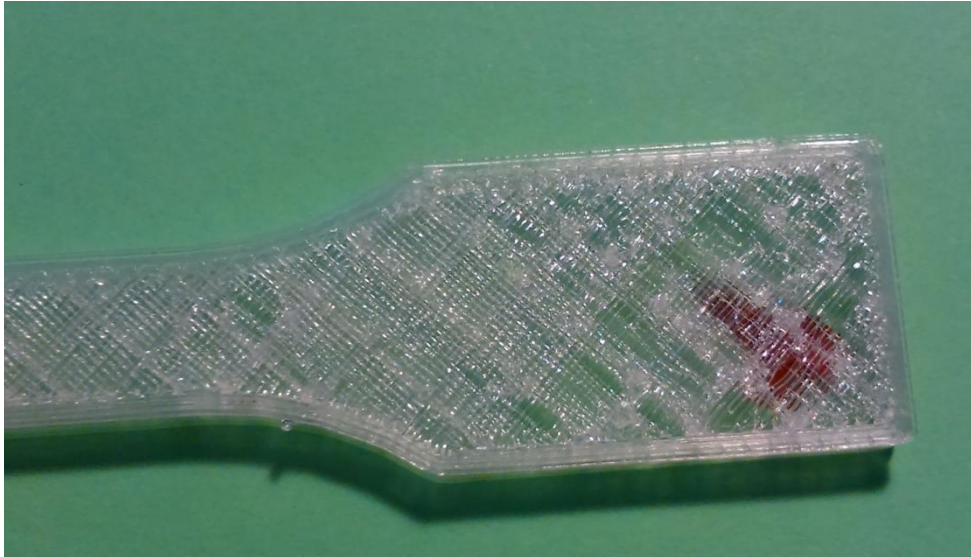
Figura 3.2.2.: Extremo de probeta donde se aprecia la falta de material durante la impresión.
