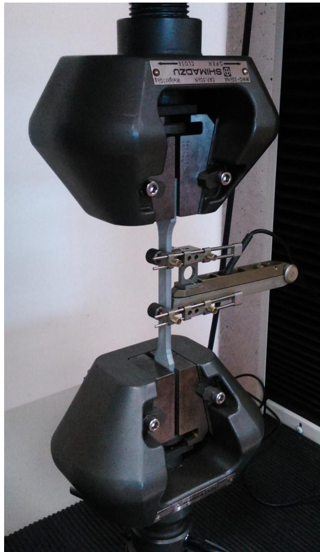
Figura 5.3.2.: Detalle del ensayo a tracción de las probetas.
