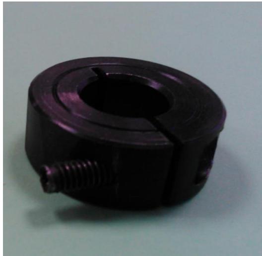
Figura 7.4.11.: Prisionero del tornillo sin fin con la cabeza de tornillo rota.
