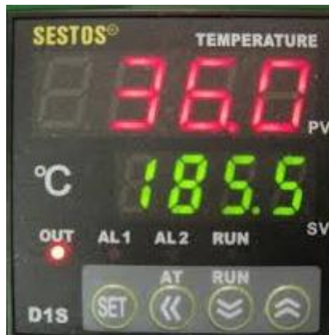
Figura 3.1.5.: Controlador de Temperatura. Valor en verde: Temperatura de consigna.
