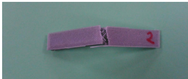
Figura 4.1.3.2.: Probeta PLA comercial tras el ensayo de flexión.
