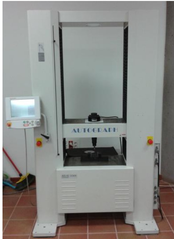
Figura 5.2.2.: Máquina Autograph para los ensayos a flexión y a tracción. [75]
