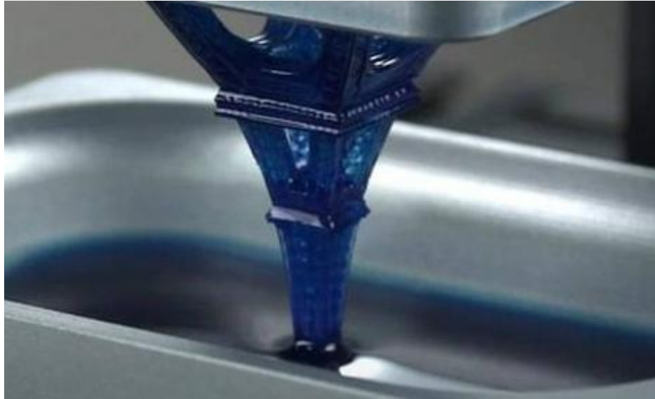
Figura 1: Detalle de impresora 3D de resina líquida. [59]
