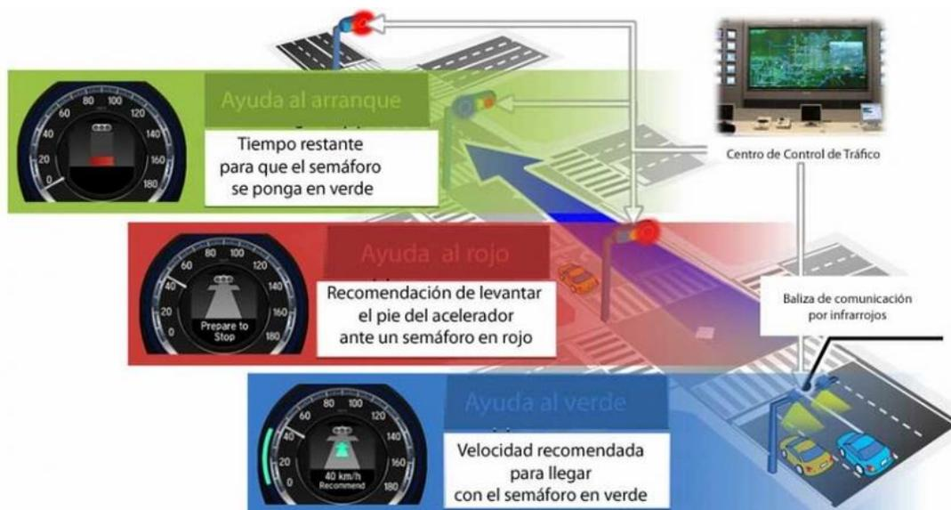
**Fig. 7.** Funciones del Prototipo Honda
